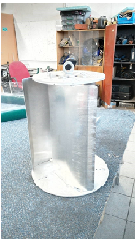
Obr. 8 Savoniův rotor před instalací. Těmito úpravami se elektrárna roztáčí již při rychlosti větru 3 m/s.
