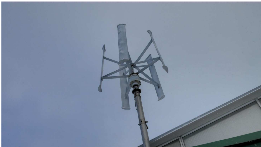
Obr. 3 Standardní Dariovo kolo přímo napojené na alternátor 48 V
