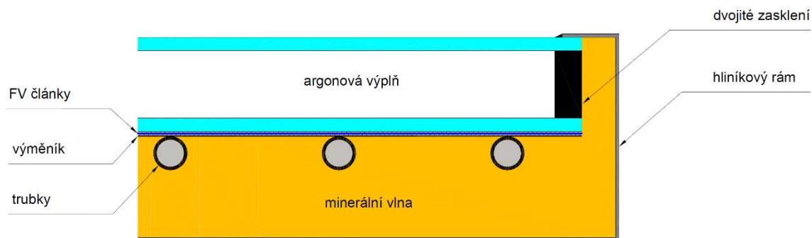
Obr. 3 Řez hybridním kolektorem
