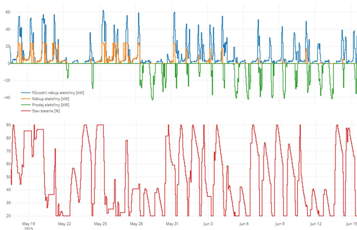
Obr. 3 Výstupy MicrOpt Design: grafy s optimálními průběhy – zoom do letního období
