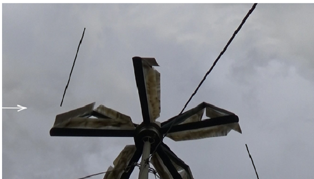
Obr. 10 Překlápění pružných lopatek nad tečnu na odběhové straně. Návětrná lopatka je tlačena do středu.
