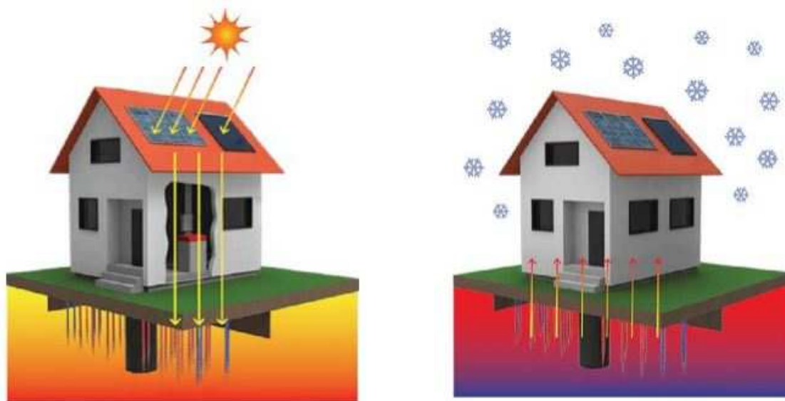
Obr. 2 Schéma fungovania ENERbank systému v letnom a zimnom režime.
