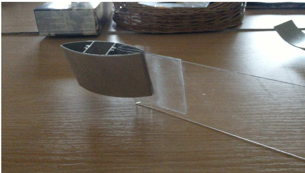
Obr. 5 Lopatka s vloženým pružným polykarbonátovým koncem a křídélky
