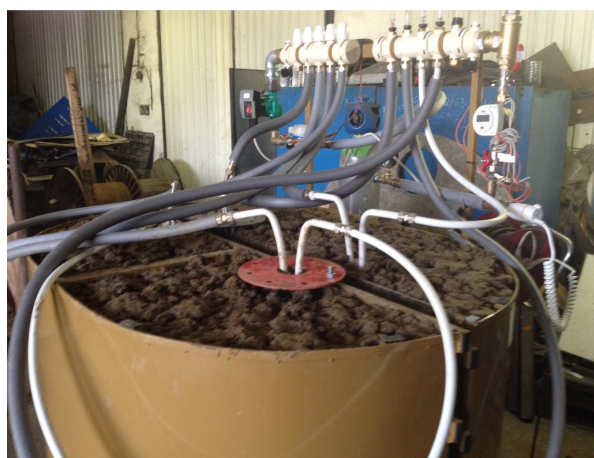
Obr. 3 Testovanie transportu tepelnej energie do geologického podložia v laboratórnych podmienkach prostredníctvom energetických ihlíc.
