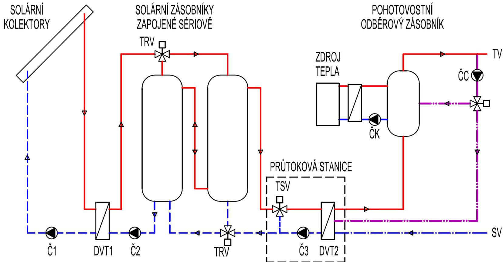
se solárními zásobníky tepla – oddělení odběrového okruhu výměníkem tepla (průtokový nebo zásobníkový předeheřev vody, dohřev dodatkovým zdrojem)
