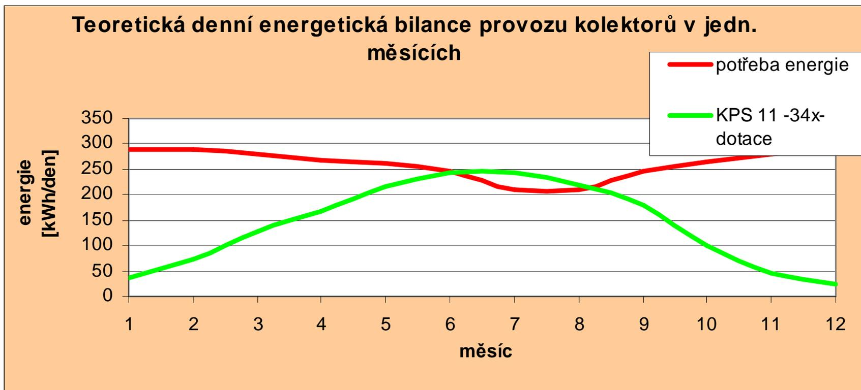
Přebytek energie (oblast mezi průsečíky křivek nad červenou křivkou potřeby energie) bude využit na krytí cirkulace a tepelných ztrát potrubí
