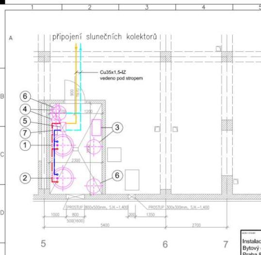
stávající rozvod studené a teplé vody ponechán beze změn, pouze dojde k dopojení přehřevu solárních zásobníků viz schéma zapojení kotelny
