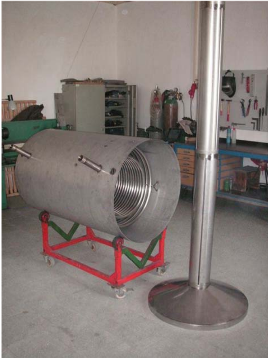
Výroba akumulční nádrže
