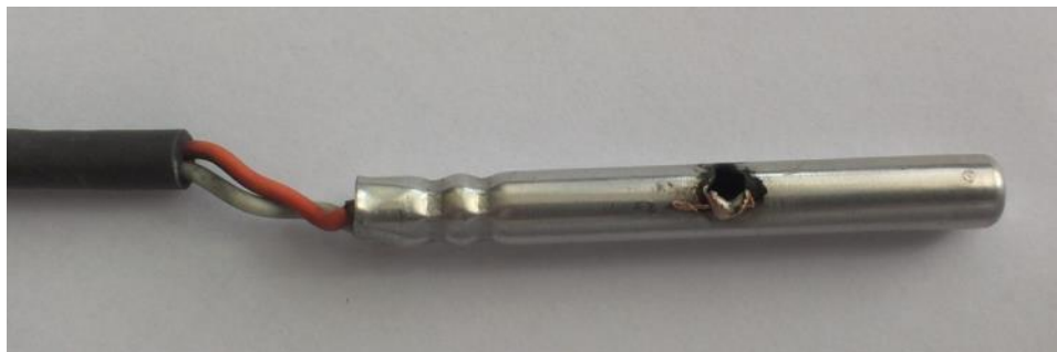
Foto: Kolektorový snímač teploty po zásahu bleskom
