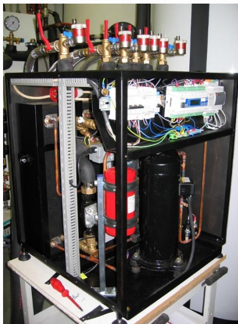
prototyp 1 (3fázový, desup, condenser) testováno v Regulusu, 2014 COP = 4.52 (B0/W35)
